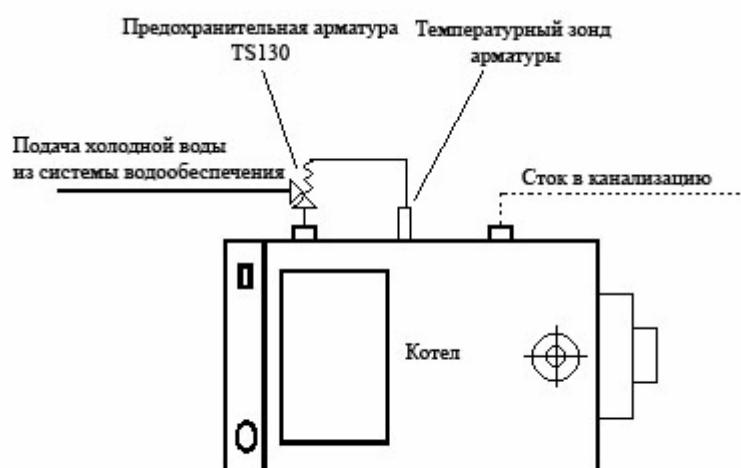
**8.2.2. Схема подключения котла к самотечной системе отопления (ориентировочная схема, не претендующая на полноту)**
