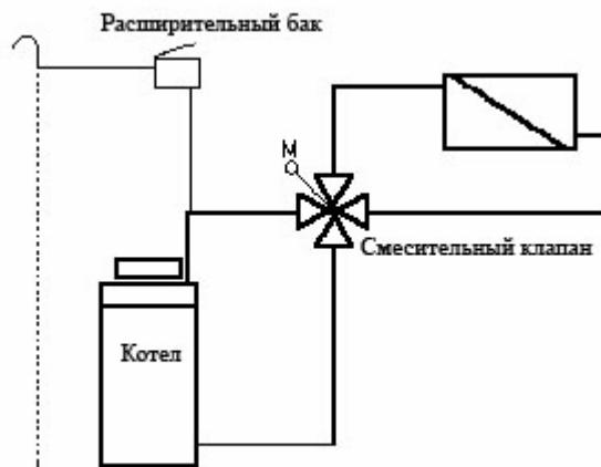
**8.2.3. Схема подключения котла к системе с напорно-расширительным баком (ориентировочная схема, не претендующая на полноту)**
