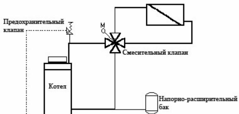
**8.2.4. Схема подключения котла к системе с принудительной циркуляцией (ориентировочная схема, не претендующая на полноту)**
