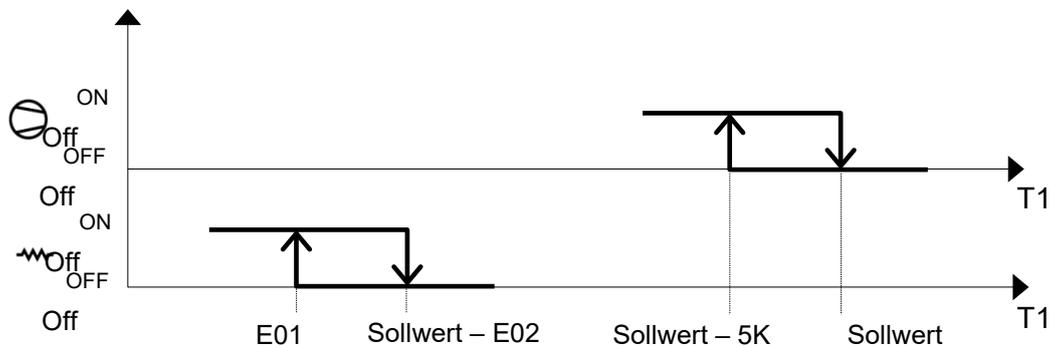
Abbildung 10: Schalttdiagramm besondere Betriebsweise E-Heizstab
