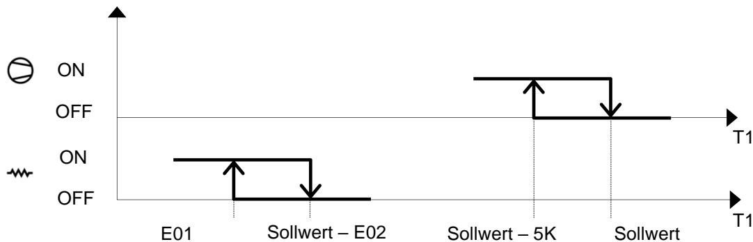
Abbildung 15 : Schaltdiagramm besondere Betriebsweise E-Heizstab
