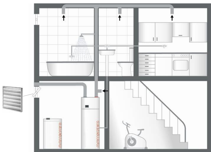
Abbildung 3: Aufstellung mit Heizungswärmepumpe mit Fortluftklappe
