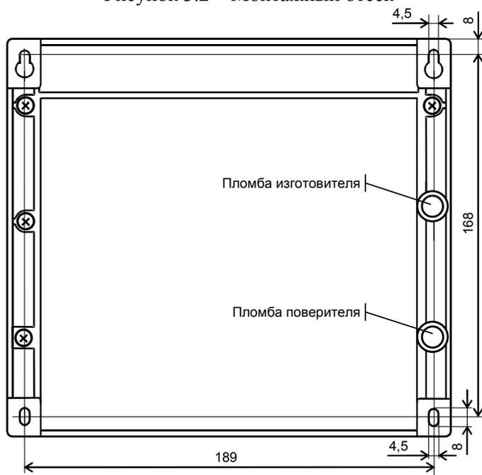
Рисунок 3.3 – Вид сзади
