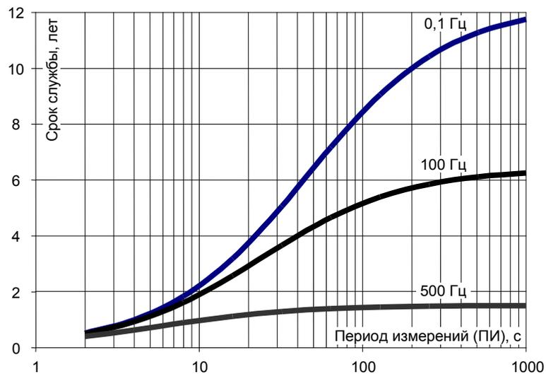
Рисунок 2.1 – Зависимость расчетного ресурса батареи от периода измерений (ПИ) и частоты входного сигнала, соответствующего расходу, (при температуре 5–25 °С, скважности импульсов не менее 10 и времени работы табло не более пяти часов в месяц)
