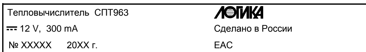
Рисунок 3.4 – Маркировка на корпусе прибора
