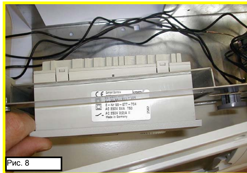
Рис. 8 ( ALTAIR – DRAGO ): Вставить блок, не закрепляя его. Блок должен быть вставлен перед фиксацией лицевой панели.
