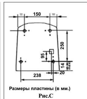
Размеры пластины (в мм.)
