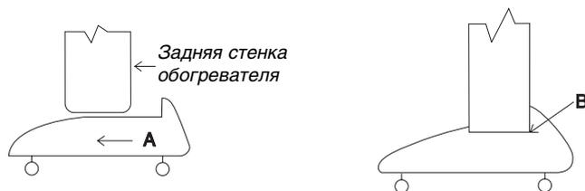
Установите выступы в нижней решетке и двигайте ножку в направлении указанном стрелкой А, до тех пор пока задняя стенка обогревателя не упрется в выступ на ножке В.
