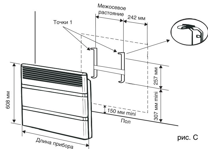
Надавив на две лапки монтажного кронштейна (точки 1, Рис. С) с помощью отвертки, отделите монтажный кронштейн от прибора.
