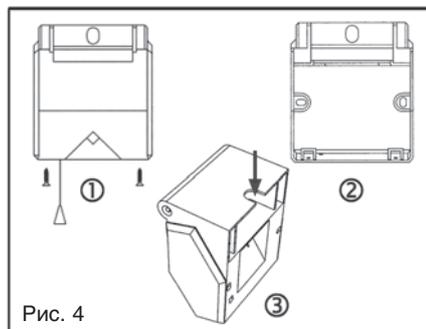
2. Прodelайте для винтов отверстия в стене; для точного выполнения отверстий используйте корпус.
