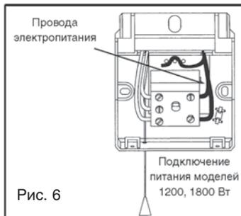
Подключите два провода электропитания к двум свободным винтовым клеммам выключателя.
