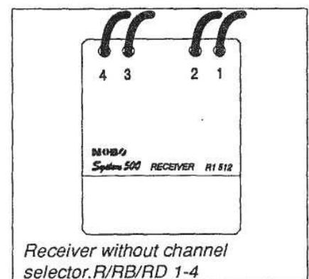
Ресивер подключается к сети с напряжением шнурами 1 и 2. Шнуры 3 и 4 могут использоваться как контакты не под напряжением, так как они подсоединяются только к контакту реле. Если к прибору необходимо подавать и отключать ток, то подсоединяются шнуры 1 и 3. Наиболее частые случаи применения:
