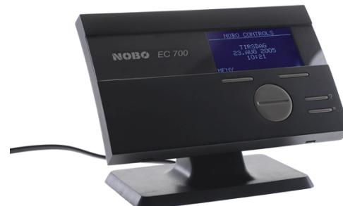
Orion 700 передает свои сигналы управления посредством радиочастотного сигнала (868 мГц). Поэтому для приёма этих сигналов необходимо использовать конвектора с термостатами R80 RDC-700
