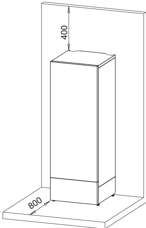
Водонагреватель – вертикально стоящая модель и требуемое ему пространство в моделях на 220 и 300 л: 600 мм x 600 мм и в 500 л: 730 x 730 мм. Водонагреватель устанавливают в вертикальном положении, в сухом помещении, вблизи дренажного колодца. При выборе места установки учесть также, что сливную трубу предохранительного клапана можно подвести к находящейся рядом канализации, и что при необходимости можно произвести дренаж водонагревателя.
