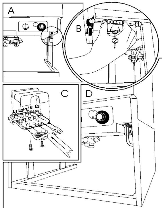
Схема электроподключения есть также на внутренней части снимаемой нижней передней панели бойлера.
