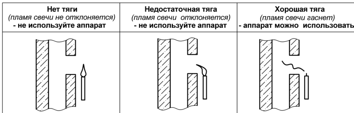
Рис. 4. Способ проверки тяги в дымоходе
