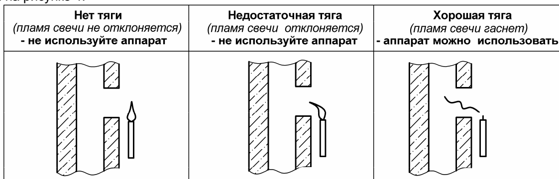
Рисунок 4. Способ проверки тяги в дымоходе
