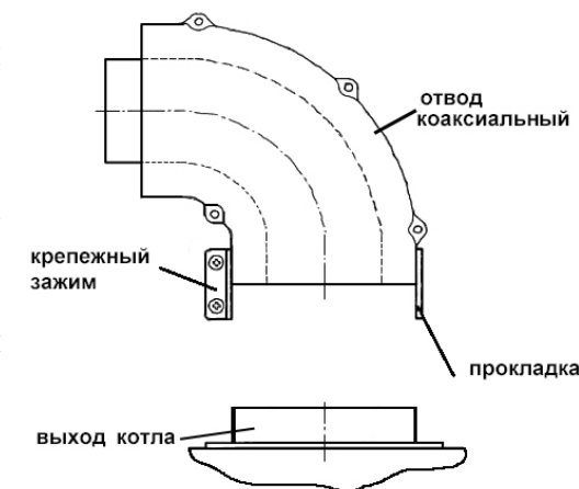
Рис. 3. Монтаж коаксиального дымохода
