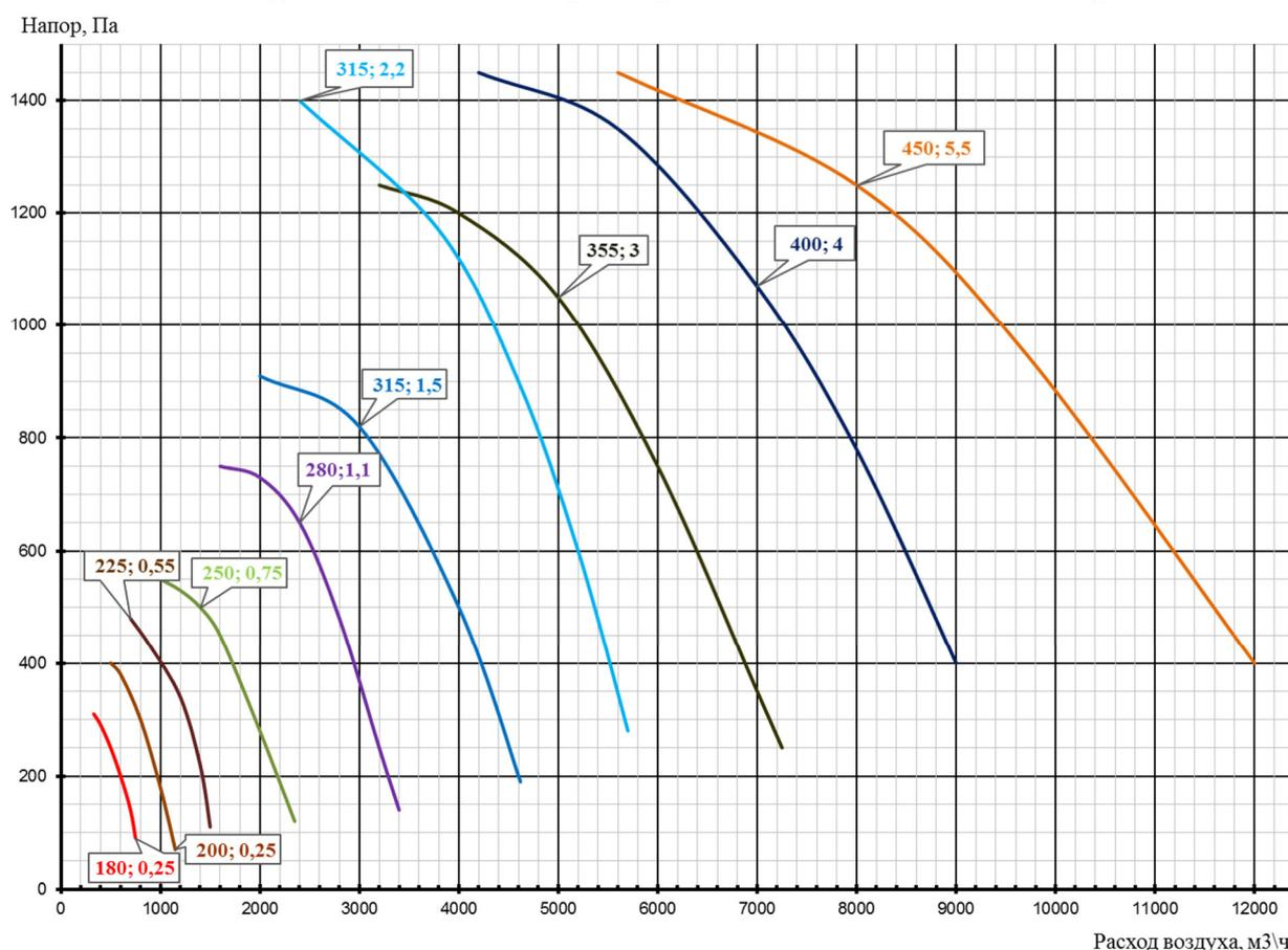
Аэродинамические характеристики приведены для рабочих колес, диаметр которых указан в обозначении. Для колеса 315; 2,2 аэродинамическая характеристика построена при частоте питающего напряжения 60 Гц.
