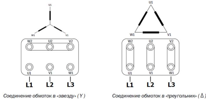
Для доступа к клеммам подключения двигателя необходимо снять крышку вентилятора, закрепленную винтами-барашками и открутить клеммную крышку двигателя. В корпусе вентилятора с двух сторон предусмотрены сальники для ввода кабеля.
