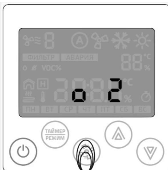
Кратковременно нажимайте на кнопку «Вентилятор» до появления меню №2. Снова нажмите на кнопку «Вентилятор»
