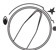
Положение „готовность” (горит только запальная горелка)
