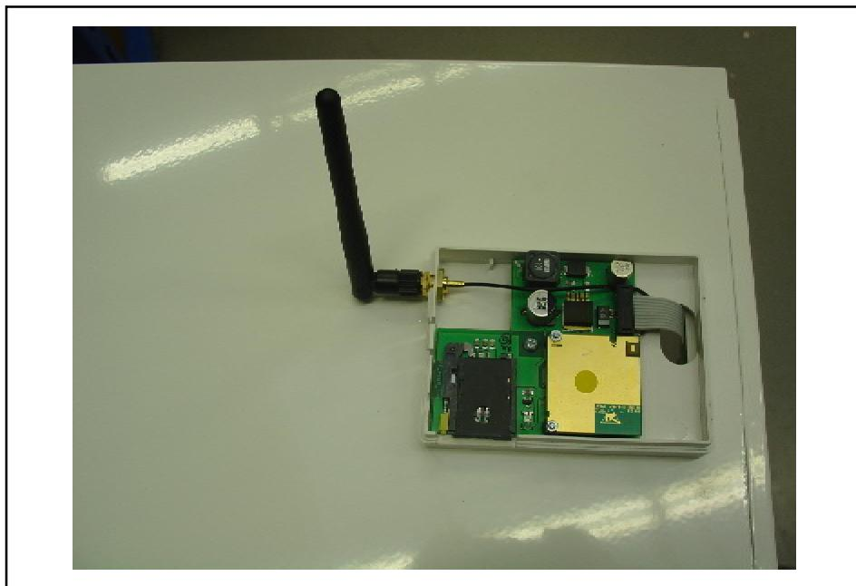
Protáhněte plochý vodič otvorem v krytu kotle. Nasad'te kryt kotle a připojte vodič do konektoru v GSM modemu. Zavřete plastovou krabičku víkem.
