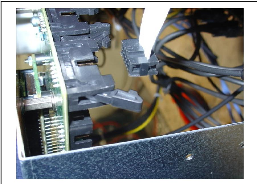
Plochý propojovací kabel připojte do konektoru označeného GSM (na okraji řídící jednotky).
