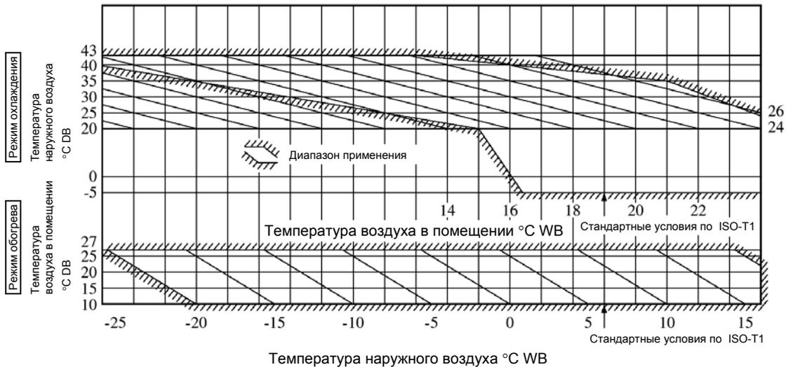
**2) Коэффициенты коррекции мощности в зависимости от температуры**
