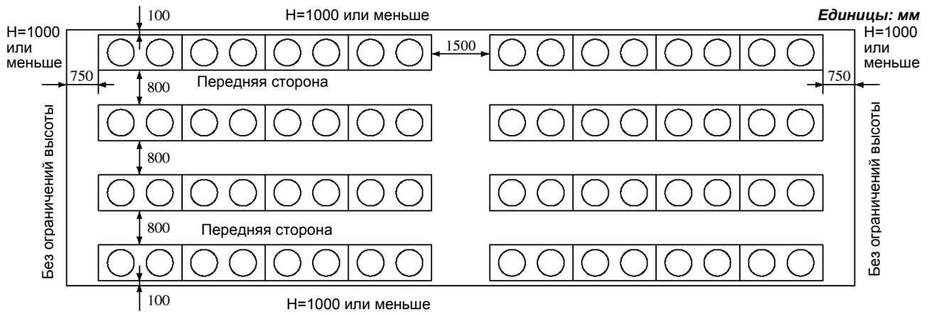
④ [Пример 2] Множество блоков установлено вертикальными и горизонтальными рядами
