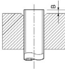
Длина выступа медной трубки для развальцовки: В (мм)
