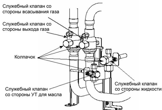
Моменты затяжки конусной гайки см. в пункте (4)-(а) «Прокладка трубопровода по месту установки».
