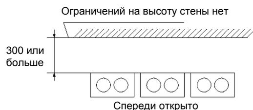
③ [Пример 1] Множество блоков установлено вертикальными и горизонтальными рядами
