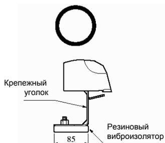
Установите резиновый виброизолятор таким образом, чтобы блок опирался на него всей нижней поверхностью крепежного уголка.
