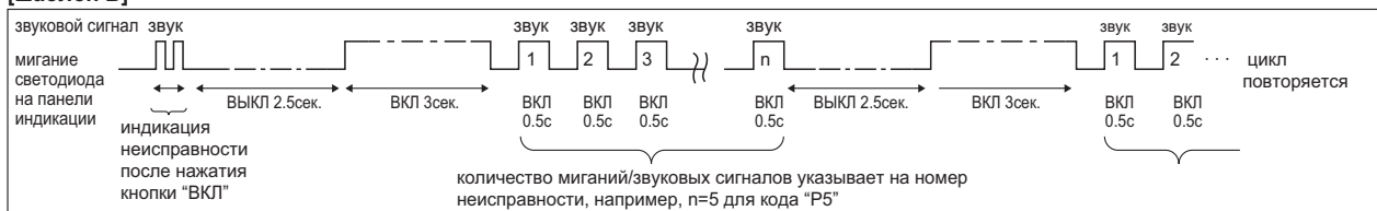
[шаблон А] Неисправность зафиксирована внутренним блоком
