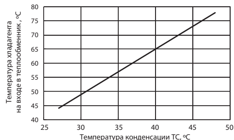
Рис. 2. Температура хладагента на входе в теплообменник
