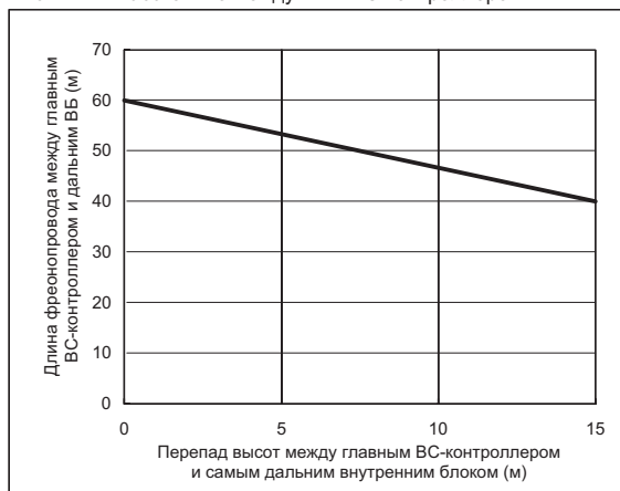
Рис. 4-1-1. Расстояние между ВБ и ВС-контроллером
