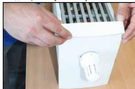
13. Закрепите кожух фиксирующими винтами
