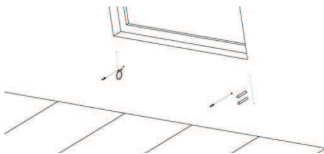
Рис. 6: Установить дюбеля в просверленные отверстия.
