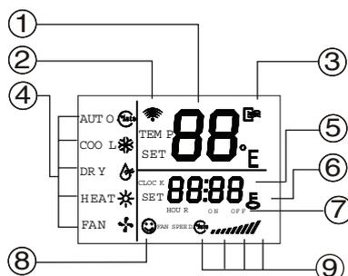
1. Индикатор температуры (TEMP): Показывает установленную температуру во всех режимах кроме режима вентиляции (FAN) . Для изменения установок используются кнопки увеличения температуры (ADJUST ↑) и уменьшения температуры (ADJUST ↓).
