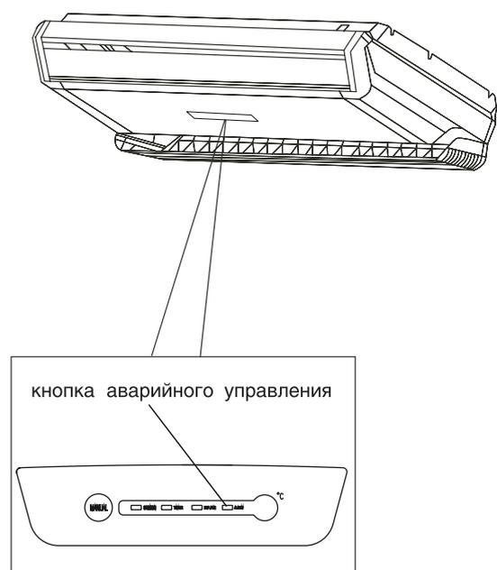
Аварийное управление применяется, если пульт ДУ утерян или вышел из строя, или разрядились элементы питания. С помощью кнопки АВАРИЙНОГО УПРАВЛЕНИЯ (MANUAL), расположенной на панели управления внутреннего блока, можно выбрать режим ОХЛАЖДЕНИЯ (COOL) или АВТОМАТИЧЕСКИЙ режим работы кондиционера (AUTO). Нажимая эту кнопку, выберите режим работы кондиционера в следующей последовательности: АВТОМАТИЧЕСКИЙ, ОХЛАЖДЕНИЕ, кондиционер ОТКЛЮЧЕН, снова АВТОМАТИЧЕСКИЙ и т.д.
