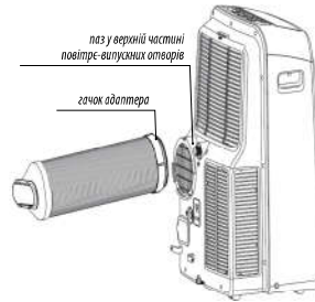
прикріплення повітропроводу до кондиціонера
