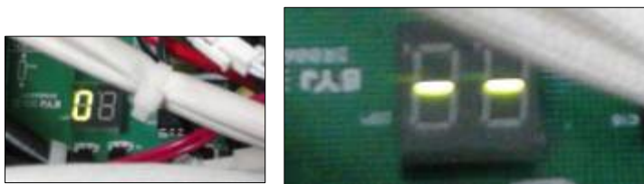
Рис. 3 Светодиодная индикация на главной плате блока при включенном питании и режиме ожидания.
