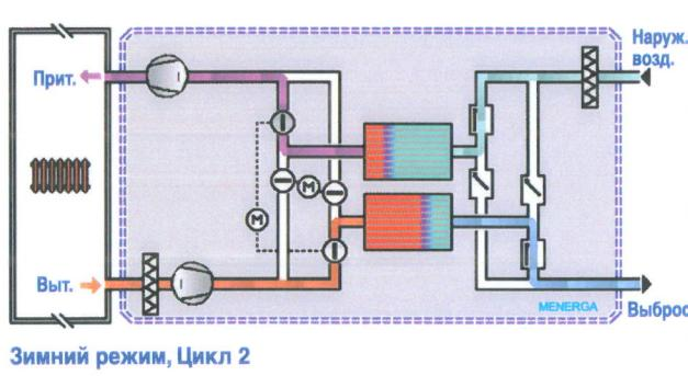
Во втором цикле наружный воздух будет нагреваться в аккумуляторе 1, а удаляемый воздух в этом цикле будет нагревать аккумулятор 2, охлаждённый в предыдущем цикле
