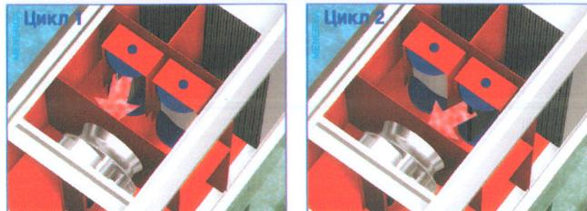
В первом цикле удаляемый воздух с помощью электроприводных клапанов направляется в аккумулятор 1 и нагревает его. Одновременно с этим наружный воздух проходит через аккумулятор 2, который был уже нагрет в предыдущем цикле.
