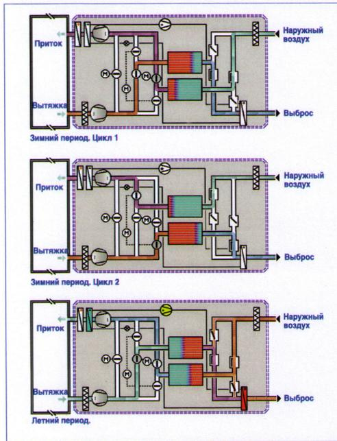
Шкаф автоматического регулирования полностью укомплектован всеми необходимыми приборами. Постоянная температура притока обеспечивается регулированием мощности холодильной машины.
