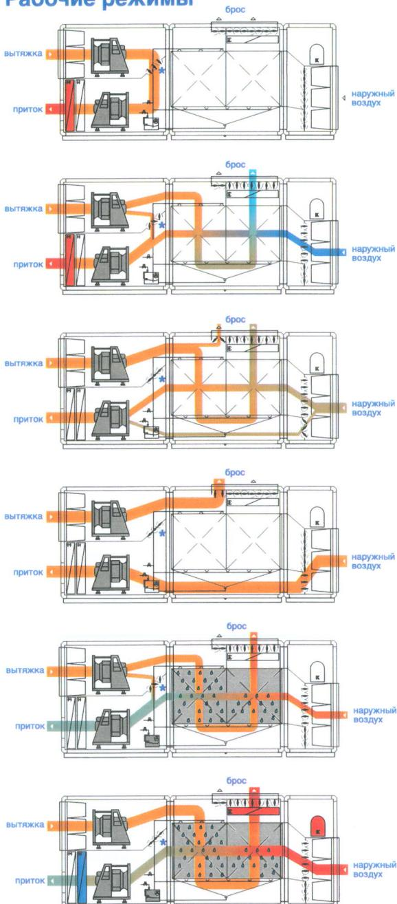
1 Зимой при отсутствии посетителей бассейна установка работает в режиме полной рециркуляции. Воздух подогревается в водяном регистре.
