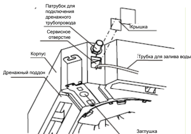
Рисунок №13 Монтаж дренажного трубопровода
