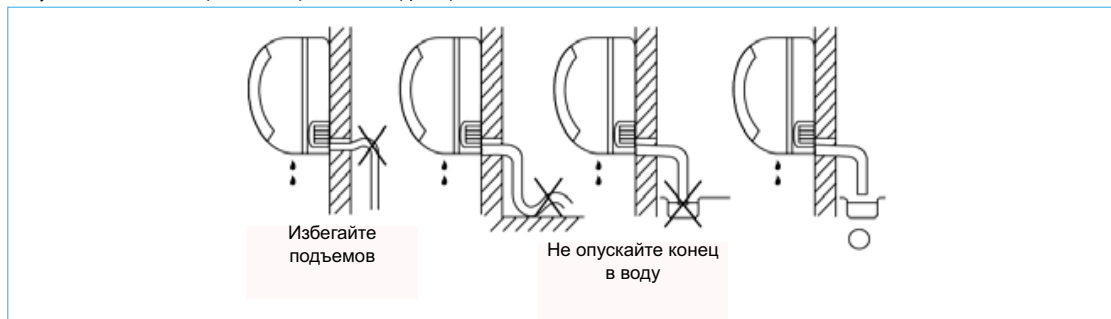
Рисунок №50 Способ прокладки дренажного трубопровода
