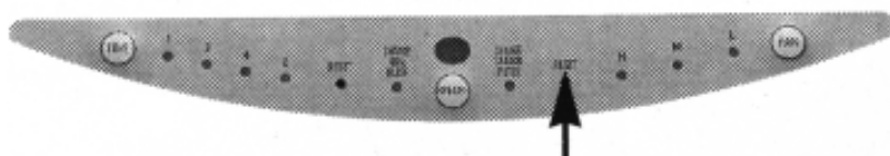
Кнопка “RESET” (кнопка инициализации)
