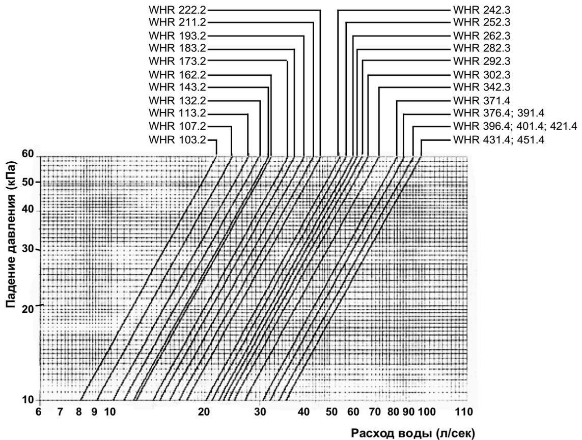
**ПАДЕНИЕ ДАВЛЕНИЯ ВОДЫ В 2-ХОДОВОМ КОНДЕНСАТОРЕ
