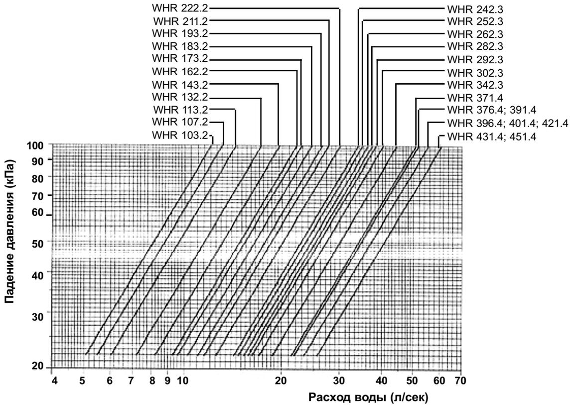
**ПАДЕНИЕ ДАВЛЕНИЯ ВОДЫ В 2-ХОДОВОМ КОНДЕНСАТОРЕ ( хладагент HFC 134a)**
