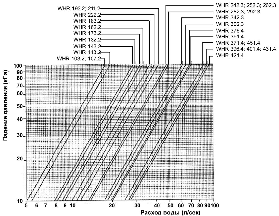
**ПАДЕНИЕ ДАВЛЕНИЯ ВОДЫ В 1-ХОДОВОМ КОНДЕНСАТОРЕ
