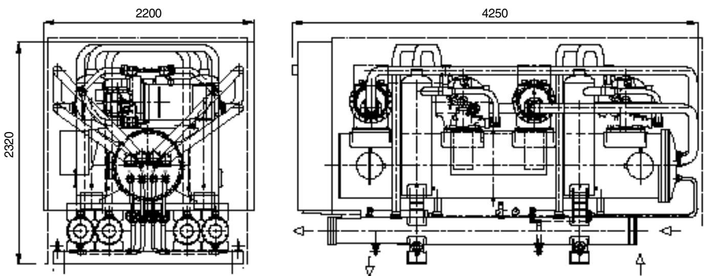
*Примечание:* Пунктирной линией обозначен контур звукоизолирующего кожуха
