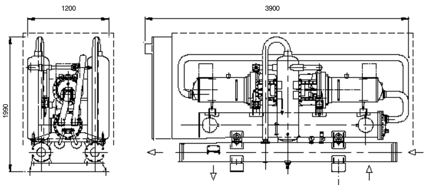
*Примечание:* Пунктирной линией обозначен контур звукоизолирующего кожуха
