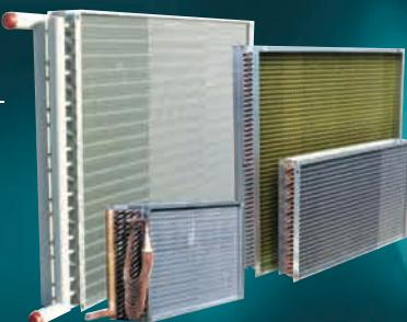
Теплообменники отличаются по конфигурации (шахматная или коридорная), толщине трубок (от 0,35 до 1,5 мм), расстоянию между ребрами (от 2 до 8 мм), материалу труб (медь, луженая медь, сталь), ребер (алюминий, медь, алюминий с антикоррозийным покрытием), типу соединительных патрубков коллекторов (резьбовые, фланцевые). Рабочее давление теплообменников – 14,7 бар.
