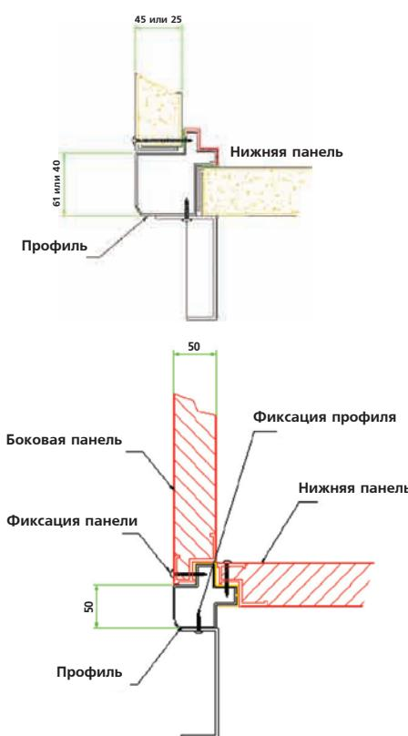
Панельно-каркасная конструкция имеет два исполнения – F.P. (Flat Panel – плоский профиль всех граней панели) и N.G. (New Generation – ступенчатый профиль панели в месте фиксации с уголковым элементом).
