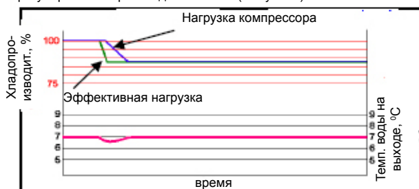
Колебания темп. воды на выходе из испарителя при ступенчатом регулировании производительности (4 ступени)
