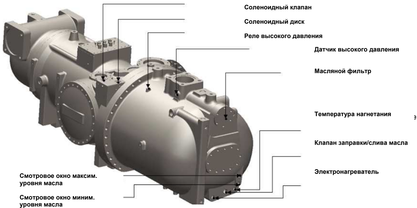
Рисунок 33 – Установка устройств управления для компрессора серии F3
