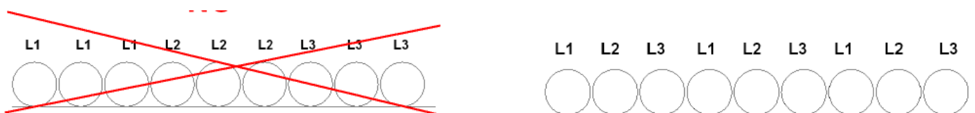
Рисунок 17 – Монтаж длинных проводов электроснабжения
