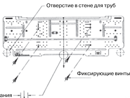
Схема монтажного основания для 020C/025CR
