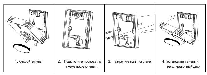
Внимание: Пульт должен подключаться специалистом в строгом соответствии со схемой подключения. Не допускайте попадания воды и грязи для предотвращения поломок.
