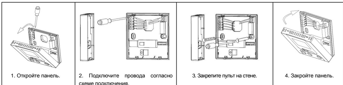
**Внимание:** Пульт должен подключаться специалистом в строгом соответствии со схемой подключения. Не допускайте попадания воды и грязи для предотвращения поломок.
