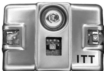
*Система мониторинга вибрационного состояния i-Alert™, на которую заявлен патент, теперь включается в предложения на поставку изделий e-SV.*
