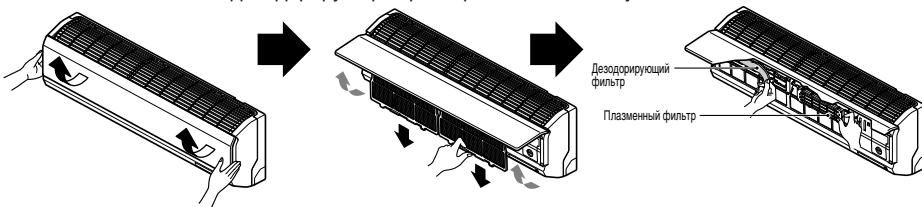
**Тип 2:** Потяните за переднюю панель с обеих сторон, как показано на рисунке. После этого потяните крепление фильтров на себя, чтобы удалить фильтр. После удаления воздушного фильтра удалите плазменный и дезодорирующий фильтры, слегка потянув их.
