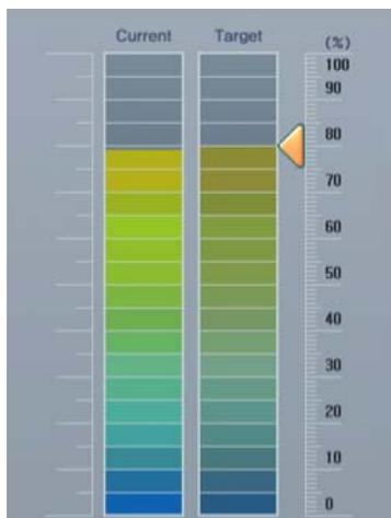
Текущее состояние работы отображается в левой части экрана управления работой по коэффициенту пиковой мощности, оно выводится в виде графика, который может задавать функцию управления по мощности.
