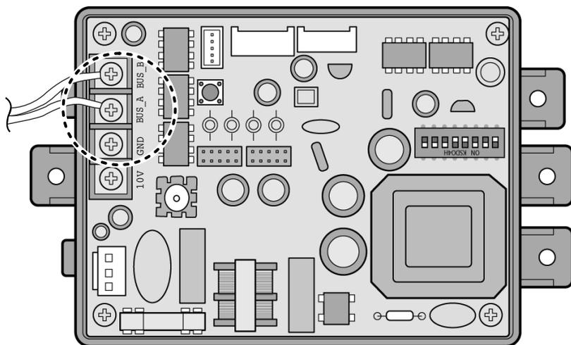
Если к одному АСР будут подключены несколько PI485, подключенных друг к другу, следует соединить шины BUS-A и BUS-B каждого PI485 с шинами BUS-A и BUS-B другого PI485.
