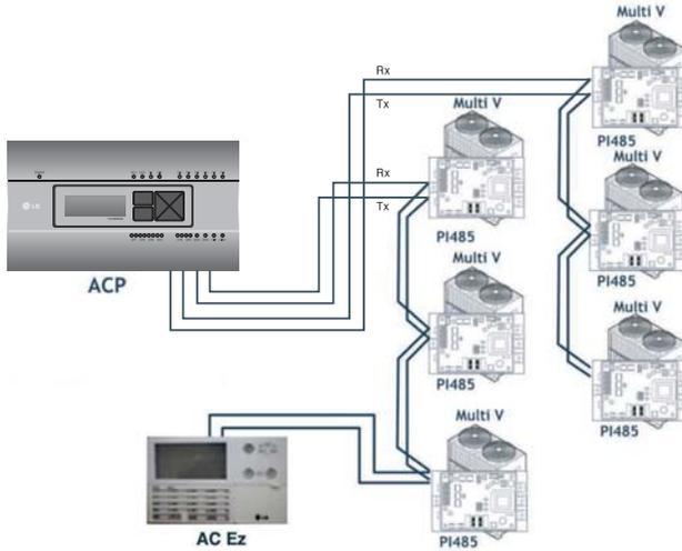
Далее приведён пример неправильного подсоединения (по топологии типа «звезда») к разъёмам RS-485 модуля АСР.
