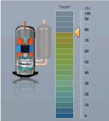
Отображается рабочий коэффициент, управляемый контроллером мощности по нагрузке. Коэффициенты работы для метода управления производительностью наружного блока могут быть выбраны из следующих 9 вариантов: 9 вариантов коэффициента работы: 0, 40, 45, 50, 60, 70, 80, 90, 100%
