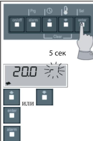
Установка зимнего режима работы (температура наружного воздуха)
