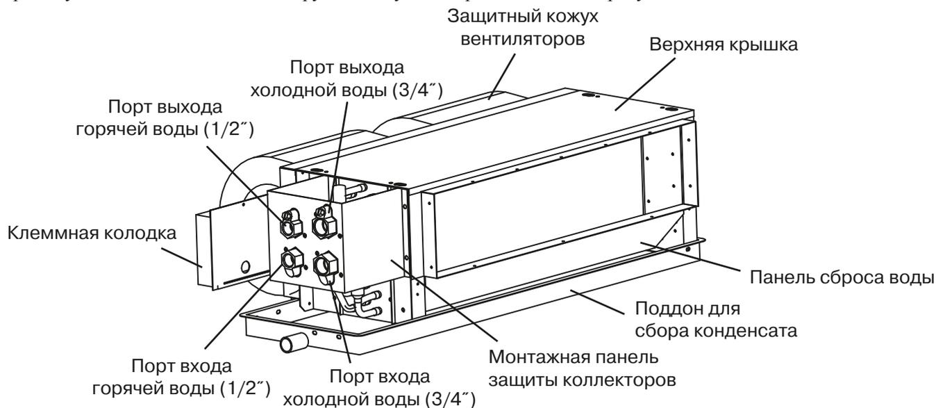
Подключайте холодную воду к портам 3/4, а горячую к портам 1/2. Порты входа и выхода дополнительно обозначены стрелками на блоке.
