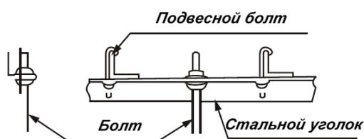
Навесьте внутренний блок на подвесные болты и закрепите. Выровняйте внутренний блок в горизонтальной плоскости при помощи уровня, иначе могут быть протечки конденсата.
