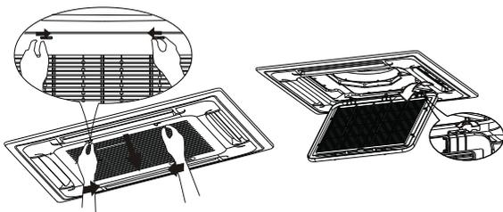
2. Смойте грязь с сетки фильтра с помощью мягкого моющего средства, тряпки и воды до тех пор, пока визуально вы не увидите не одной пылинки.
